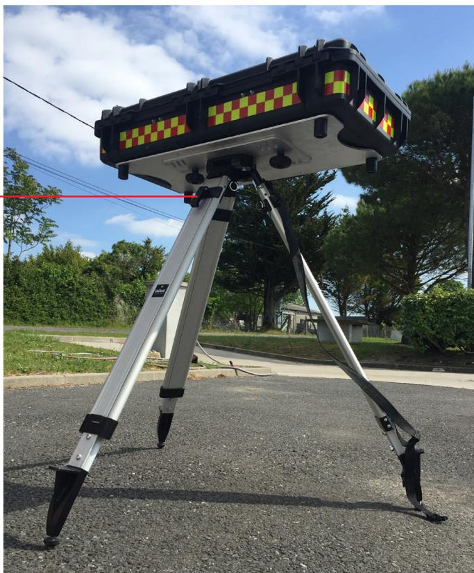
Levier de verrouillage rapide pour l'extension des 3 pieds (système "quick clamps")
